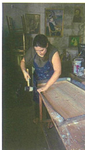
Imagem 5 – Aplicação de folha de flandres, dobragem da folha com maço de borracha
